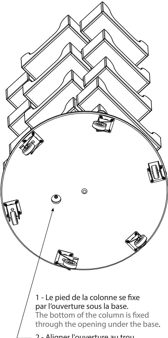
1 - Le pied de la colonne se fixe par l'ouverture sous la base.
